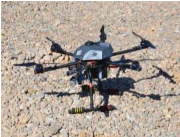
Sistema aéreo de medición de gases contaminantes basado en un UAV, -Publicado: 09/2015
