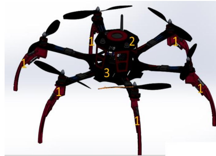
Diseño en software CAD de unidad de monitoreo en VANT Fuente: (Elaboración propia)
